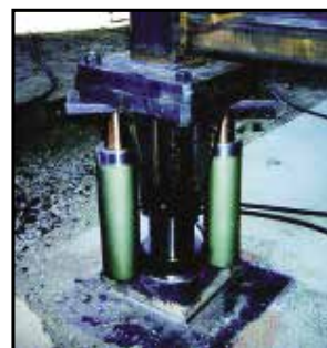
Des entrepreneurs ont fait appel à la force brute des vérins Simplex R5513 pour soulever et mettre en place des rampes d'accès à San Diego. La G6 a fourni puissance et contrôle dans cette rude application extérieure.
