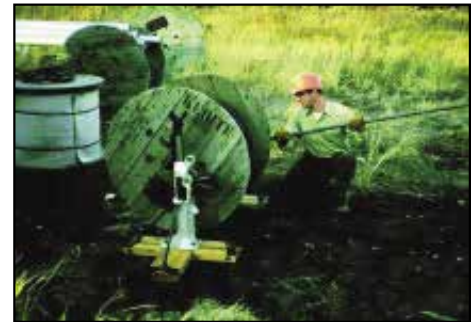
En utilisant A1029-R et A1029-L, les services publics peuvent facilement manipuler de grandes bobines. Les grandes bases en bois et de faibles efforts à la poignée améliorent la sécurité et réduisent la fatigue de l'opérateur. Les crics mécaniques pour bobines Simplex sont aussi un excellent choix pour les fabricants de câbles métalliques et d'élingues.
