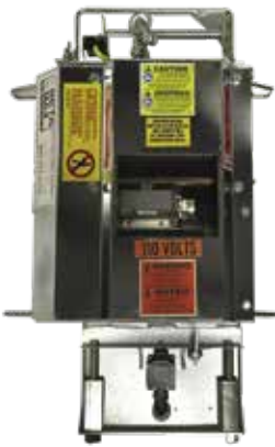
Motor del montacargas
